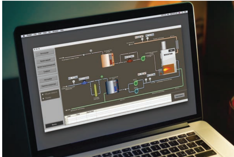
Программа визуализации работы котельной
